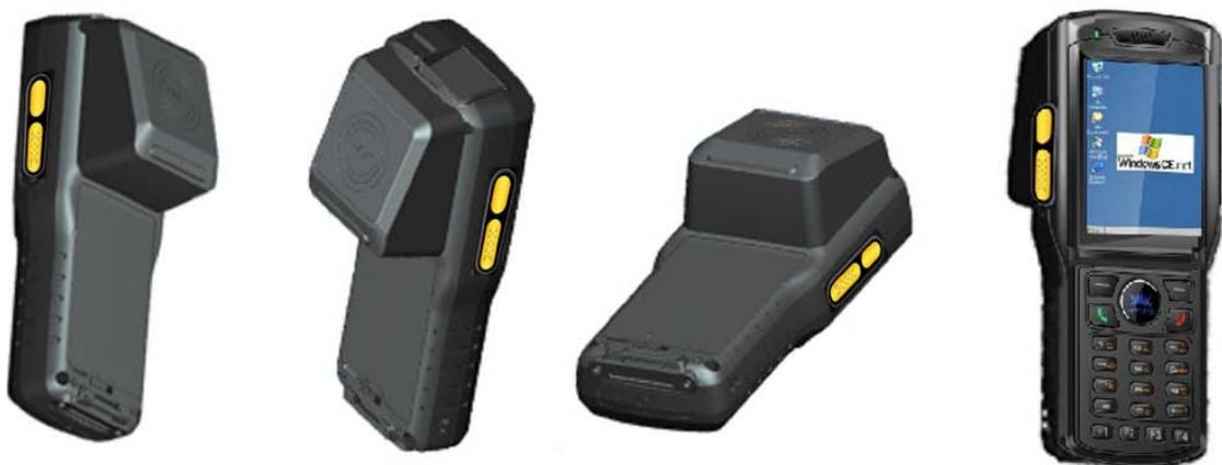
SR-6601：13~28±1dBm 大功率超高频 RFID 手持读写器，可选模块：一维条码、二维条码、GPRS/WCDMA、LF/HF/UHF RFID 等；
